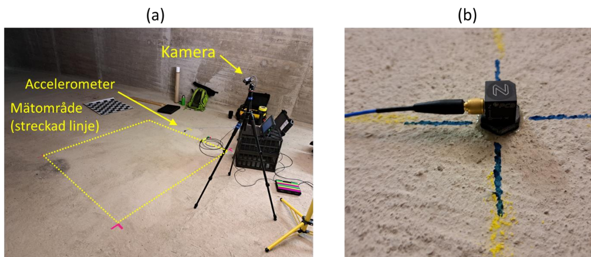
Figur 35. Översikt av mätområde (a) och närbild av triaxial-accelerometer (b) monterad på balklådans golv.
