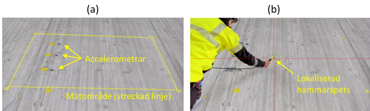
Figur 18. (a) Bild från systemet för datorseende. Bilden visar mätområdet (streckad linje) med tre styck accelerometrar (markerat med tre pilar). (b) Bild där hammarens spets lokaliserats automatiskt genom bildanalys.
